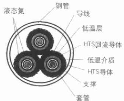
图5 带分立低温层的CDC电缆截面图
